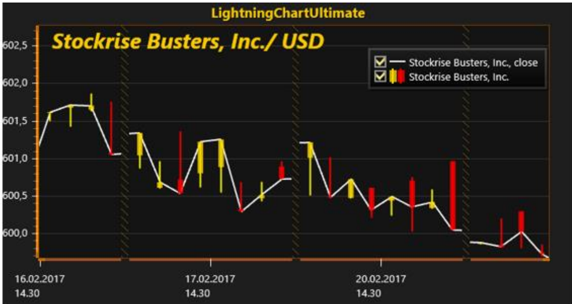
图 6-37. PointLineSeries.ContinuousOverScaleBreak = False . 在间隔间，前一点到下一点的线不相连。相反，这些线继续保持原来的方向，就像没有定义尺度中断一样。
