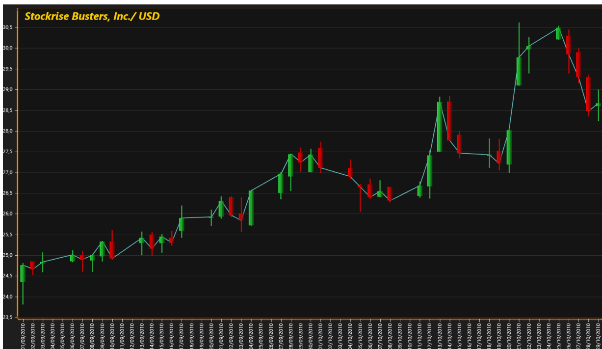
图 6-61. 设置 StockSeries 样式 Style = CandleStick. 淡蓝色的线是后面的一个 PointLineSeries, 贯穿所有收市值。
