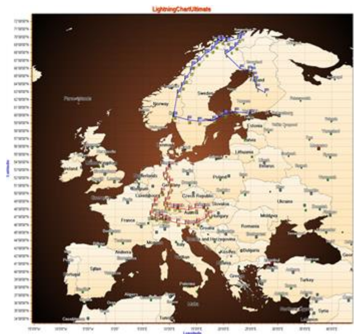
图 6-108. 欧洲地图，用几个 FreeformPointLine 系列作为路线。对其添加旗子标志作为鼠标交互的路径点。
