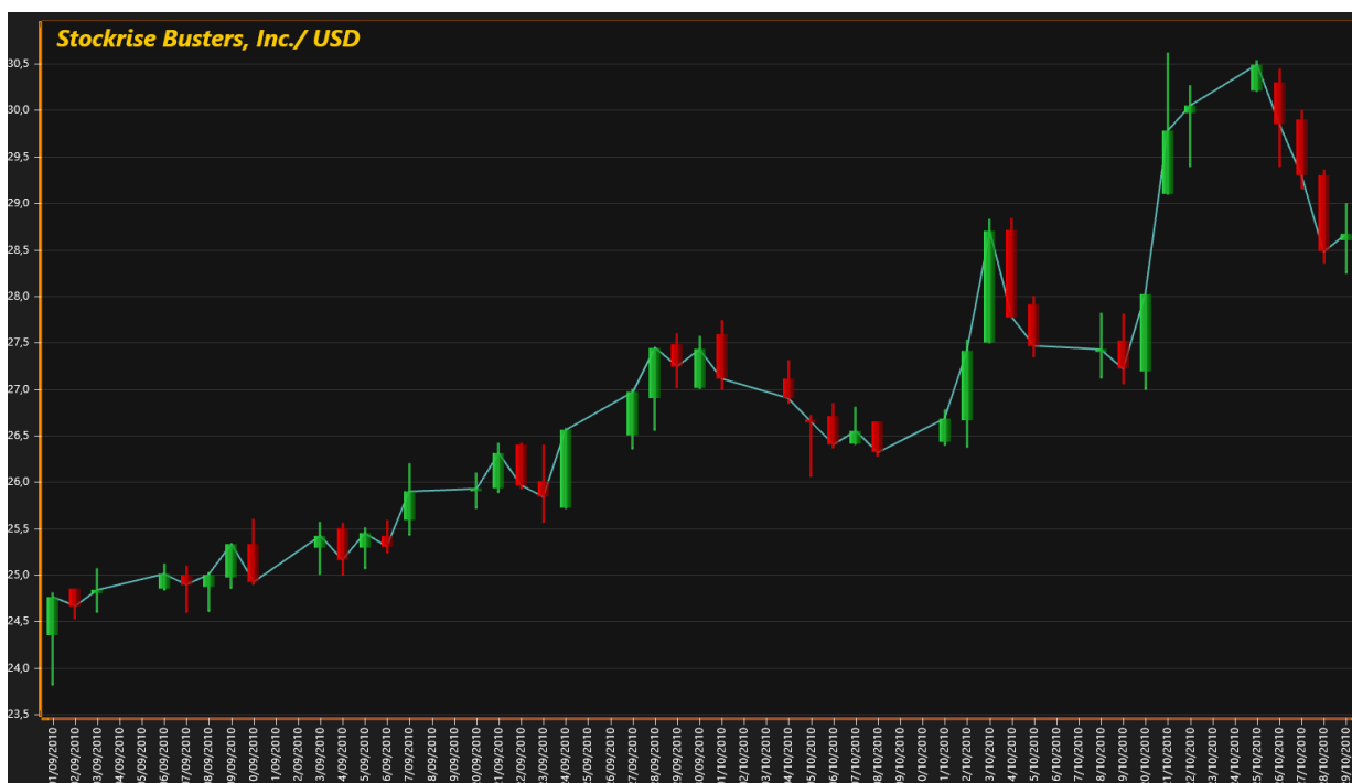
图 6-62. 设置 StockSeries 样式 Style = CandleStick . 淡蓝色的线是后面的一个 PointLineSeries ，贯穿所有收市值。
