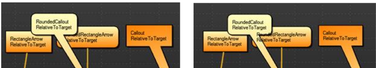
图 6-82. 左侧， LayerGrouping = False ；右侧， LayerGrouping = True ，文本的 Z 序丢失。
