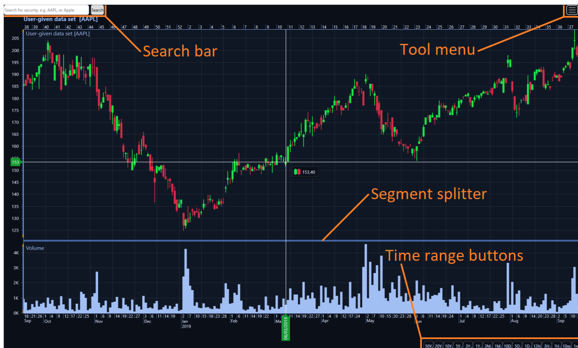
图 18-4. TradingChart 的主用户界面组件，都可以通过禁用相应的属性进行隐藏。
