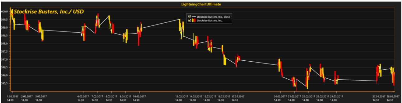
图 6-34. 原始交易数据，周一至周五，上午 10 点至下午 6 点。没有应用 ScaleBreaks。大部分时间范围内并没有数据，这是因为证券交易所已经关闭，难以看到必要的信息。PointLineSeries 从收市值开始跳变。
