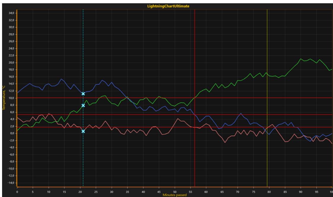
图 6-125。线系列光标：右侧光标（青色线和十字线），样式 PointTracking ，垂直点跟踪光标。中间光标（红线），样式 HairCrossTracking ，细线十字跟踪光标（水平线与 LineSeriesCursor 本身颜色相同）。左侧光标（黄线），样式 VerticalNoTracking ，无跟踪的垂直全长光标。
